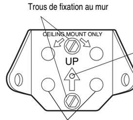
Le trou du clou n'est prévu que pour le positionnement seulement. Des tire-fond doivent être utilisés pour fixer le support de linteau.
